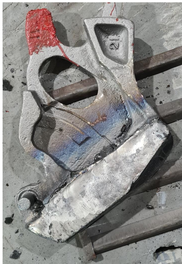
Рис.1. Наплавка ИМС порошком ЗТС-4857ИН.
